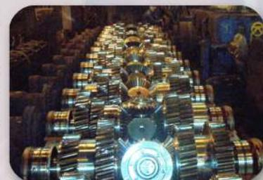
Nous disposons, au sein de nos ateliers, un banc d'essais dédié spécialement aux machines tournantes. A la demande de nos clients les plus exigeants, nous sommes en mesure d'effectuer différents test et mesures, tels que : contrôle de température, analyse vibratoire, contrôle thermographique etc..
