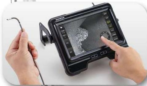
L'endoscopie, par l'introduction d'une sonde vidéo de petit diamètre dans l'équipement à inspecter, permet de réaliser un contrôle visuel de l'état interne d'une machine tournante. Cette technique est avant tout utilisée pour la détection de dégâts par pièce libre, d'usure prématurée importante ou de fissuration des pièces internes.
