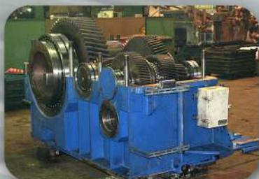
Tous les réducteurs ou machines tournantes remis en état en nos ateliers, font l'objet d'un essai final sur banc et sont livrés sous garantie\* avec certificat et dossier technique.
